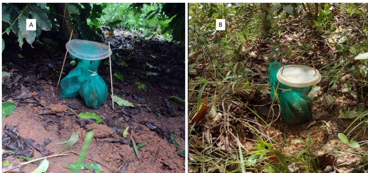
Figura 3 – Estação para calibrar a perda e/ou ganho de umidade em áreas de (A) Cafeeiro e (B) Floresta, Santo Antônio do Amparo - MG, Brasil.
