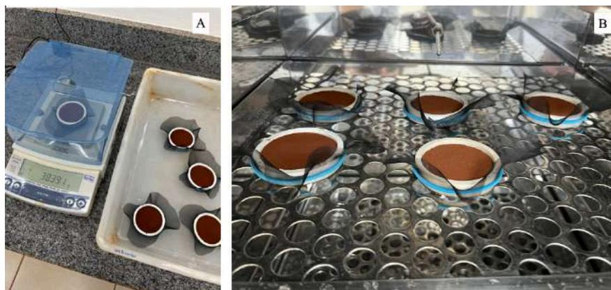
**Figura 4** – Pesagem da massa das amostras após saírem da câmara de Richards (A); Anéis de polipropileno em estufa de secagem (B).
