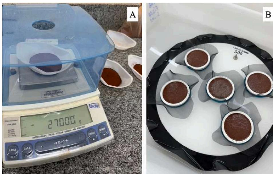
**Figura 2** – Pesagem do solo em balança semianalítica (A); Anéis polipropileno sobrepostos em placa de cerâmica (B).
