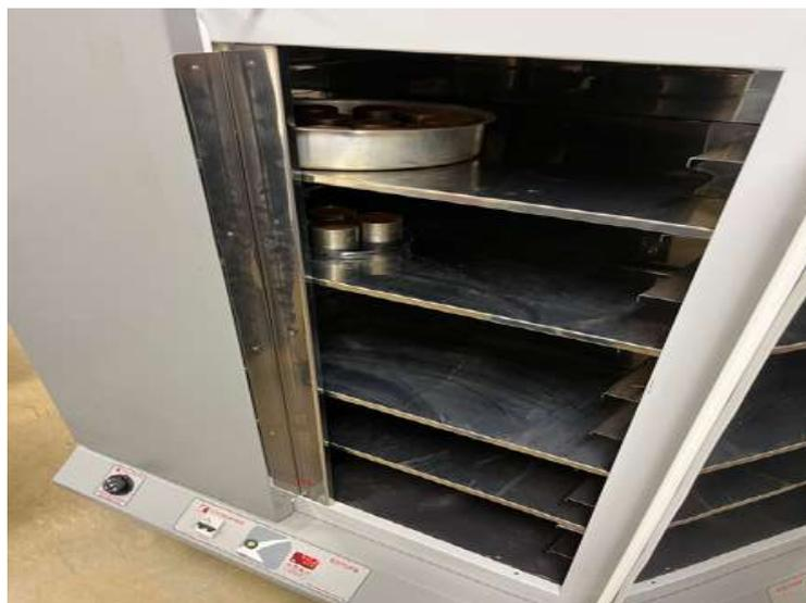
**Figura 5** – Estufa de circulação de ar forçado, estabelecendo seus 105°C para secagem das amostras.
