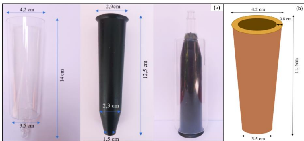
Figura 5 – Moldes utilizados para a fabricação dos tubetes e dimensões após moldagem.
