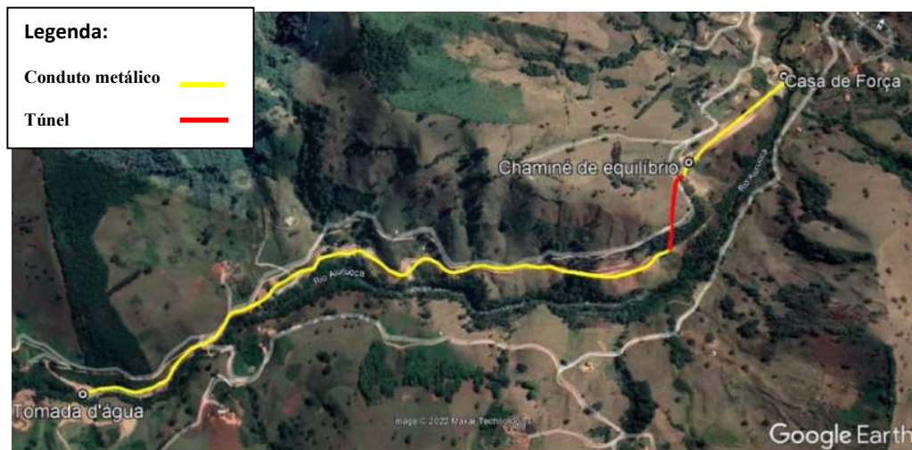
Figura26 - Traçado do conduto de baixa pressão após o túnel (projeto executado)
