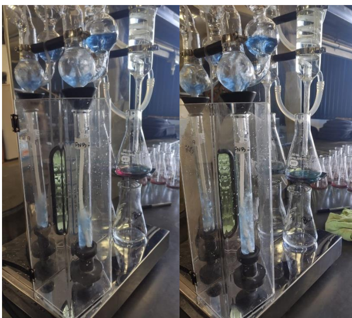
Figura 5 – Destilação em destilador de nitrogênio tipo Kjeldahl com adição de NaOH 50% e Solução de \text{H}_3\text{BO}_3 com indicador misto. Fonte: O autor.
