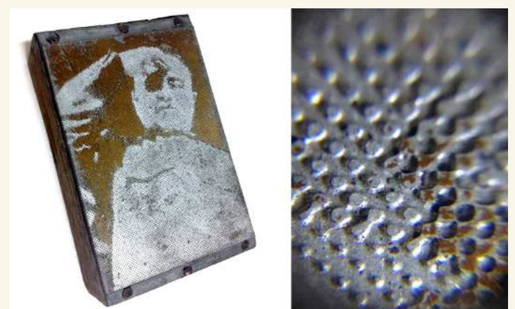
Figura 3: Clichê fotográfico autotípico obtido por retícula de linha cruzada para impressão em prensa tipográfica (à esquerda) e detalhe ampliado evidenciando os pontos gravados em alto relevo (à direita). Fonte: La Ilustracion Española y Americana .
